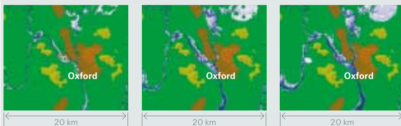
Figure 11 Evolution temporelle des surfaces inondées dans la région d'Oxford (Grande-Bretagne) au cours d'une crue probabilistique (augmentation du niveau de l'eau du bleu ciel au bleu foncé).
